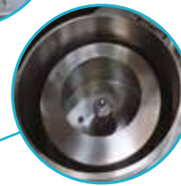
Standardní dekantační neperforovaný buban Ø 200 mm (užitný objem 1,2 litru) nebo Ø 300 mm (užitný objem 5,5 litru) nebo buban se dvěma páry otvorů v jeho horní části, opatřeny závitovými zátkami, pro nastavení různých procesních užitných objemů.
